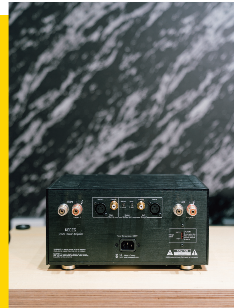
機背輸入連接為標準的RCA及XLR各一組。位於RCA輸入之間的搖頭開關，左邊為切換訊號輸入源，右側為切換橋接模式。
